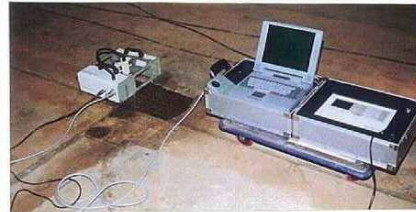
石油貯蔵タンク アニュラー板 測定状況
